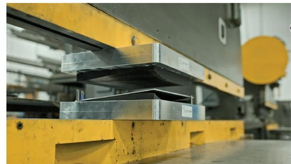
Mit den 3D-gedruckten Matrizen wird ein Blechteil geformt.
